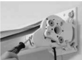
① Neigung durch Drehen der Einstellschrauben mit Innensechskantschlüssel (4 mm) einstellen.
