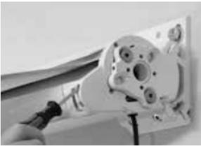
③ Neigung durch Drehen der Einstellschrauben mit Innensechskantschlüssel (4 mm) einstellen.
