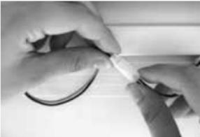
3. Steckverbindung zwischen Platine und Akku trennen.
