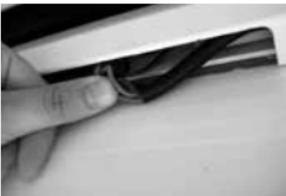
6. Steuerplatine und Kabel-Verbindungen vorsichtig in die Rahmenöffnung einschieben.
